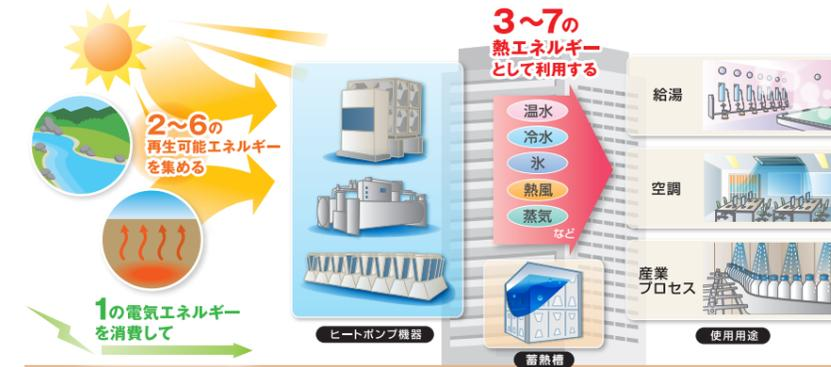
ヒートポンプ機器は、熱と圧力の性質を利用して、空気をはじめ河川や地中、海水などの自然の熱\* (再生可能エネルギー)を「集めて」、必要なところに「運ぶ」ことによって、冷房・暖房や給湯をはじめ、工場の製造工程などにも利用されています。また、蓄熱槽と組み合わせることにより、電気需要最適化と省エネルギーを同時に実現することができます。
